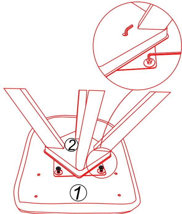
Danach werden alle Schrauben mit dem Inbusschlüssel gleichmäßig angezogen.
