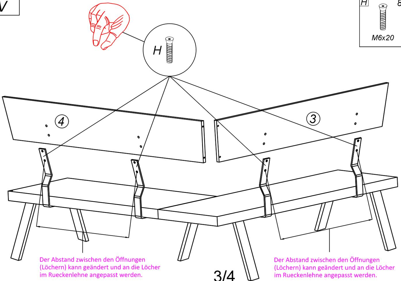
Der Abstand zwischen den Öffnungen (Löchern) kann geändert und an die Löcher im Rueckenlehne angepasst werden.
