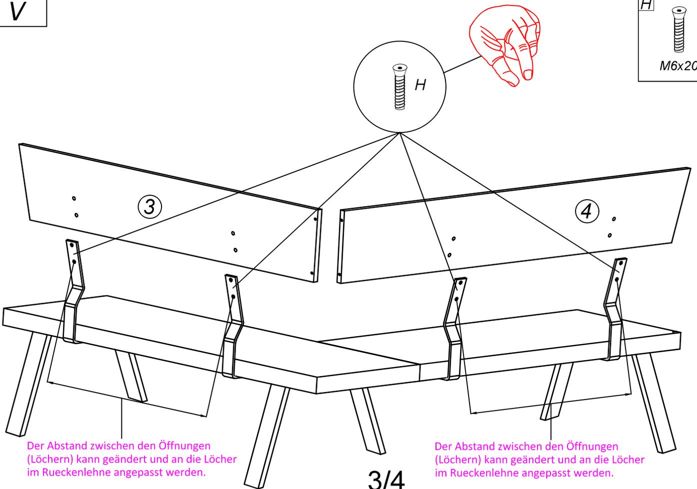
Der Abstand zwischen den Öffnungen (Löchern) kann geändert und an die Löcher im Ruckelehne angepasst werden.
