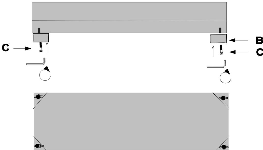
2.2 Betten flach auf den Boden stellen, Netzkabel des Motorrahmens mit Steckdose verbinden und Motorrahmen hochfahren. Bett etwas anheben und Füße in die Bohrungen des Eckwinkels einschieben, mit U-Scheibe und Flügelmutter am Eckwinkel anschrauben.
